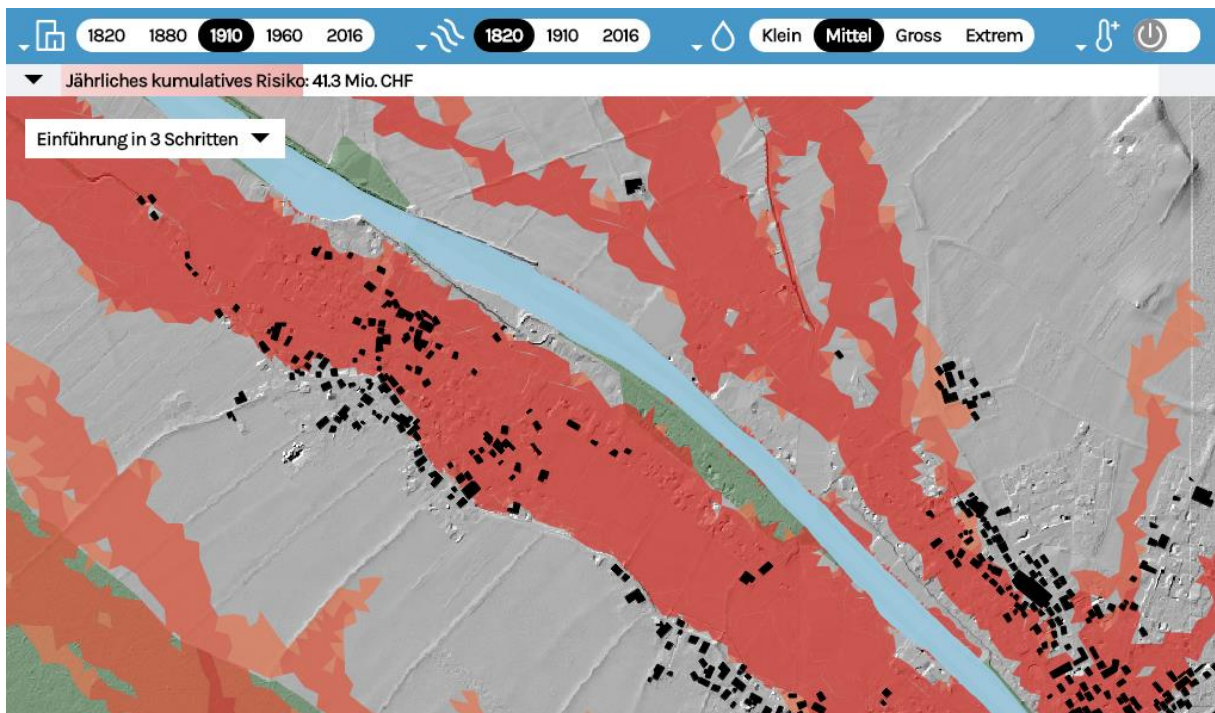
Abb. 4: Die Regler erlauben eine isolierte Betrachtung der vier Faktoren Siedlung, Flusslauf, Grösse des Hochwassers und „Klimazuschlag“. Das Hochwasserrisiko ist einerseits in Form von überschwemmten Flächen sichtbar. Andererseits wird es für den simulierten Abschnitt mit Frankenbeträgen angegeben.
